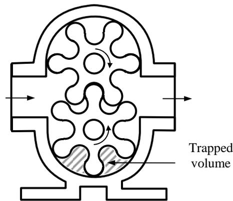
*Fig. 5.4: Gear Pump*
