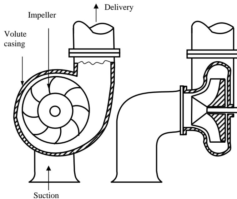
*Fig. 4.1: Centrifugal pump*
